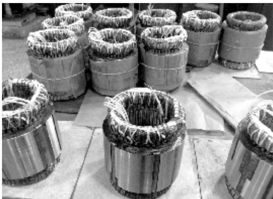
Двигатели асинхронные трехфазные с короткозамкнутым ротором встраиваемого хладомаслостойкого исполнения со встроенными датчиками температурной защиты предназначены для привода герметичных и бессальниковых поршневых холодильных компрессоров.
